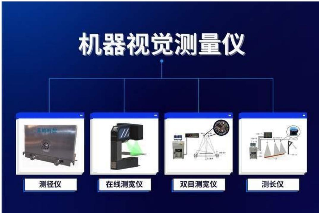
蓝鹏机器视觉测量仪器主要由硬件设备及软件系统组成。其中硬件设备主要包含：工业相机、相机冷却防护壳体、辅助光源、工控机等，软件系统为自主研发的测控软件系统，不同的测量需求、测量仪器配置不同的测控软件。
