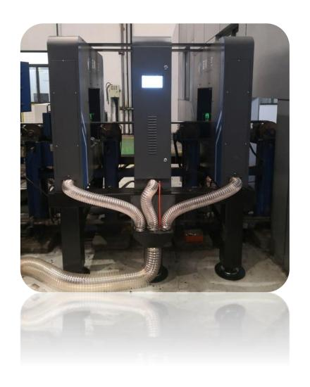
在线直线度测量仪为钢材自动化生产研发的智能测量设备,能够为钢管、线材、棒材、管材、方钢、方管等各种圆形、方形制品实现更简单、更安全,更高效的生产检测过程。
