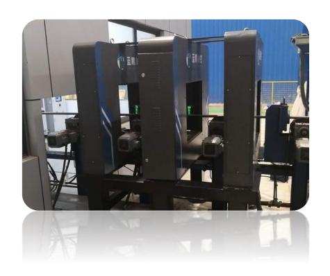
当棒材通过直线度测量仪的测量区时,3 台位置测量仪同步采集 3 组 X 轴和 Y 轴的位置数据。
