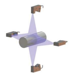
独创的光线拟合算法,将不平行光的参数通过跑数,提取出来,测量时反向应用,提高测量精度。
