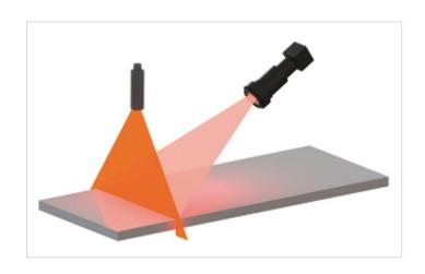
光线过强时,则根据轧制产品实际情况设置滤光镜片,去除火焰和轧材表面 黑斑的影响。
